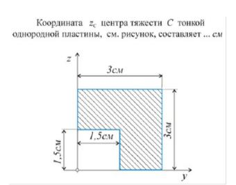
5 Продемонстрируйте знание стандартных методов расчета и проектирования деталей и узлов технологических машин и оборудования, решив задачу. (ОПК-13.1)
